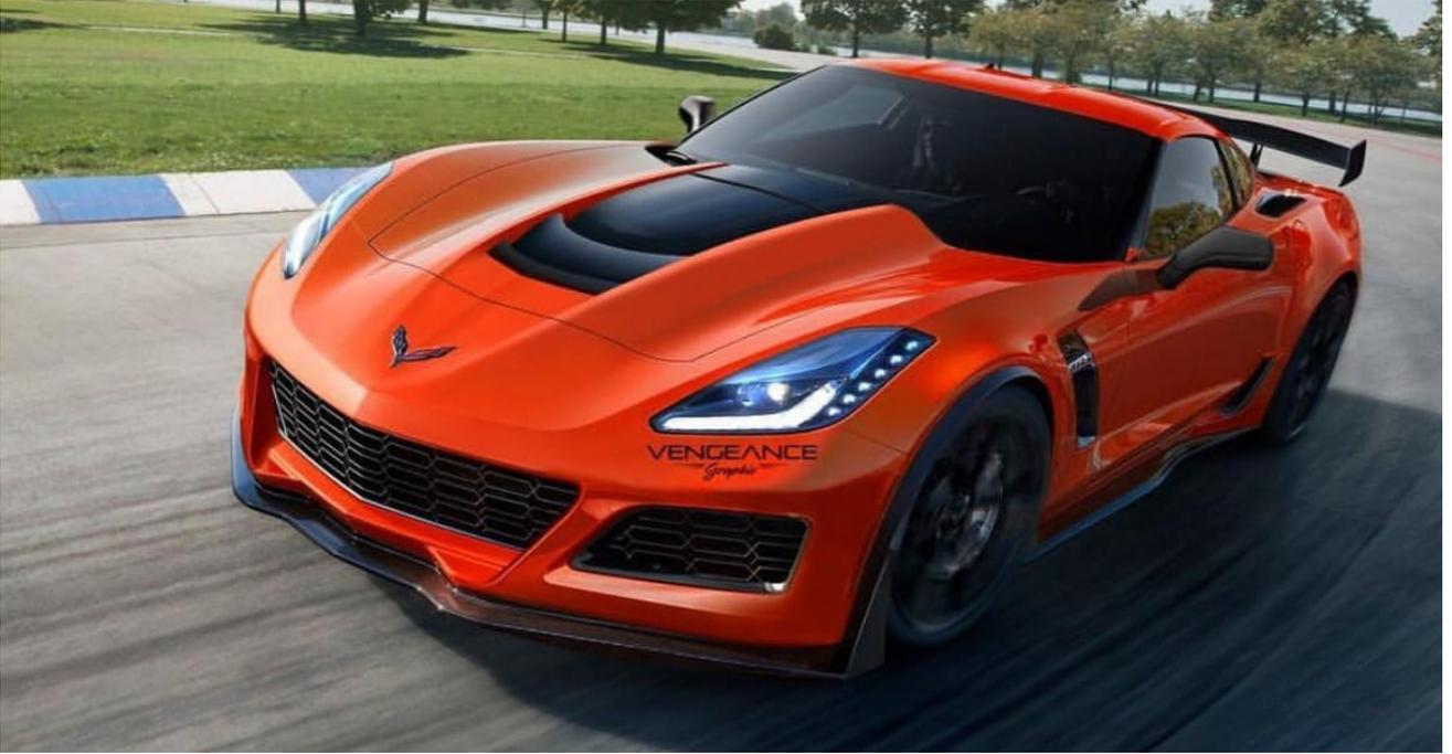
وتتمتع السيارة ZR1 ببعض التعديلات على المآزر، مع فتحات كبيرة لهواء التبريد، كما حظيت السيارة بأسبويلر أمامي جديد وأسبويلر خلفي من ألياف الكربون. وتعتمد السيارة على مكابح الكربون/السيراميك، مع جنوط قياس 19 بوصة بالأمام و20 بوصة بالخلف.
